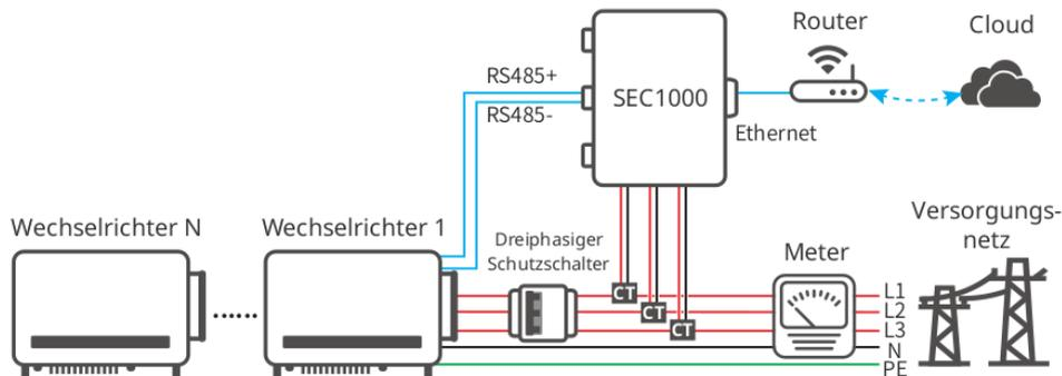
Nach dem Anschluss der Kabel können Sie die Steuerung der Export- oder Ausgangsleistungsbegrenzung über die entsprechenden Parameter auf dem LCD oder in der SolarGo-App einstellen.
