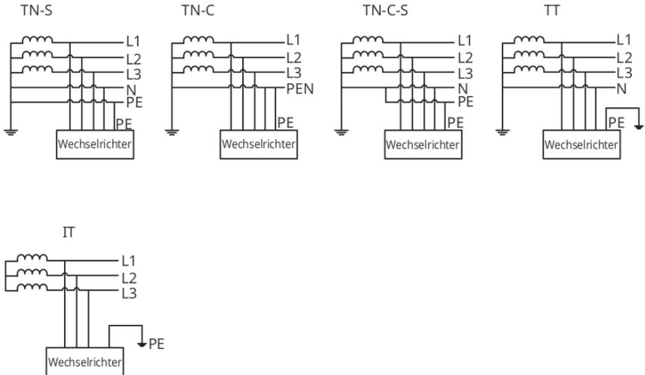
Das von GW136K-HTH unterstützte Netzsystem ist IT, wie in der Abbildung unten gezeigt:
